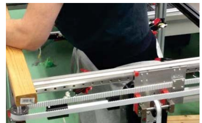
改良クリップで腰部を伸長している様子。改良前では伸長不可能だったジャージ+リハビリパンツの条件でも脱落することなく伸長できている
