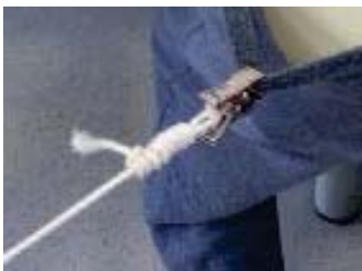
改良前：クリップが小さく、ロープが直接連結されているため遊びがない
